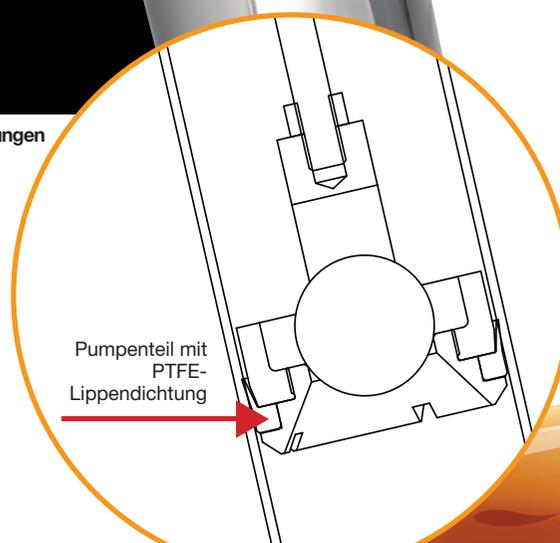
Pumpenteil mit PTFE-Lippendichtung
